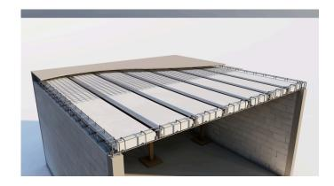
Colocación de la capa de compresión Se recomienda esparcir el concreto de manera uniforme, evitando concentrar el concreto en un solo punto y de esta manera prevenir algún posible desperfecto en el material utilizado.
